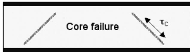
图 11 芯材的剪切破坏
