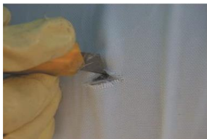
图 7.3.10 将扎头部分外面防紫外线膜划开
