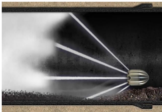
图 1 喷射铰头工作示意图
