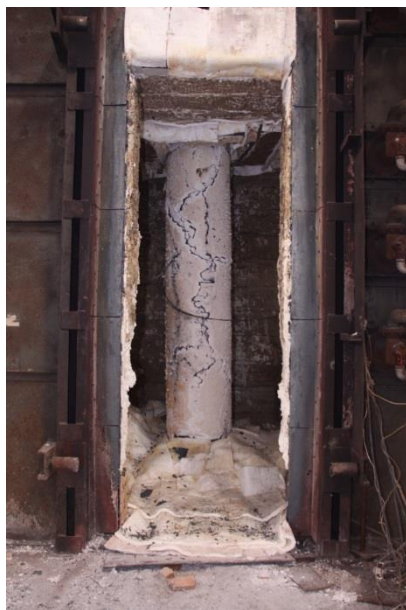
图 7.1.3-1 膨胀型防火涂料保护的钢管混凝土柱标准火灾试验：受火 3.0h 后
