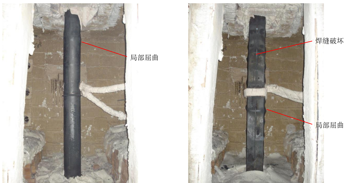
(a) 圆不锈钢管混凝土柱
