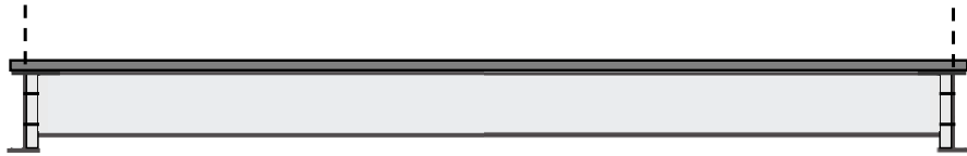
图 7.2.1-1 斜拉桥组合钢板梁横截面示意
