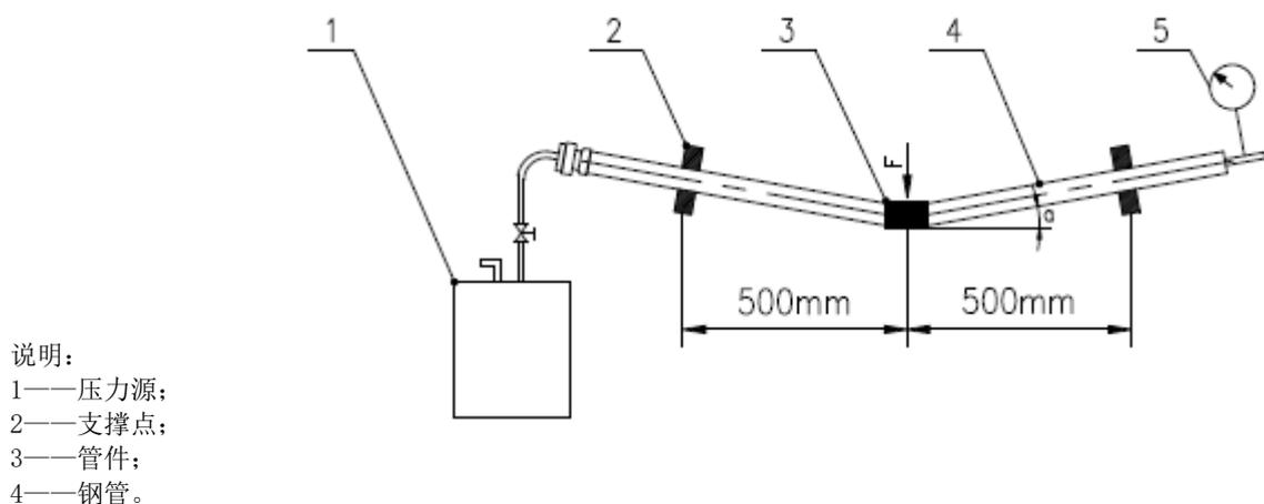
图5 水压弯曲试验装置
