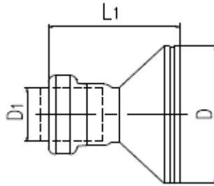
图B.1 GCRC管件
