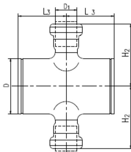
图B.3 GCRS管件
