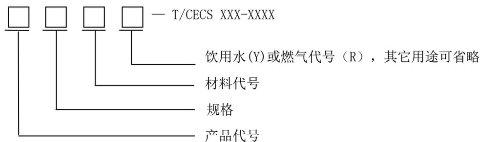
注1：标记顺序：以卡压连接的大端为起始端，按顺时针方向依次标记；对于有螺纹连接端的管件，卡压连接端在前，螺纹连接端在后。
