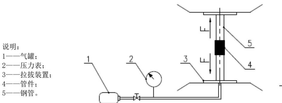
图2 拉拔试验装置
