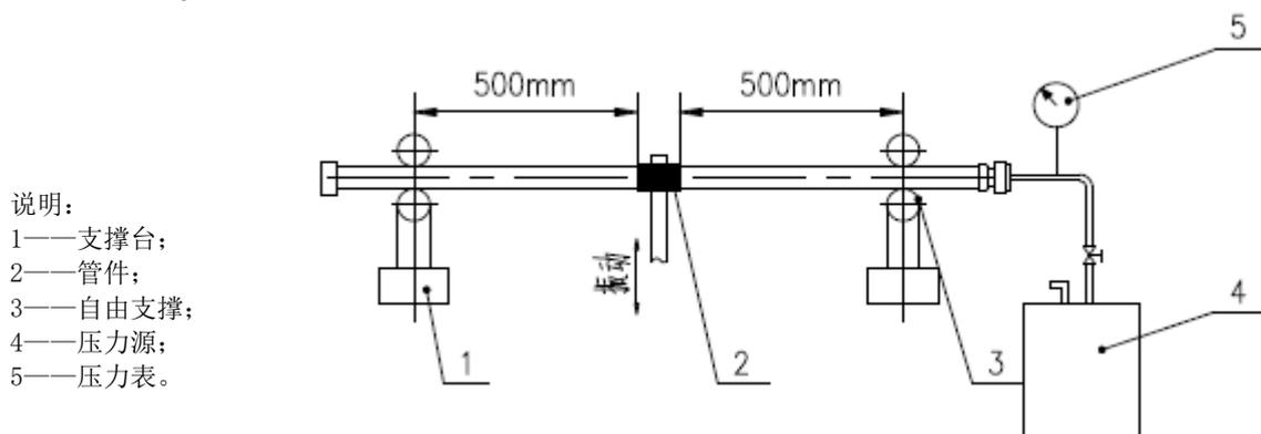
图4 振动试验装置
