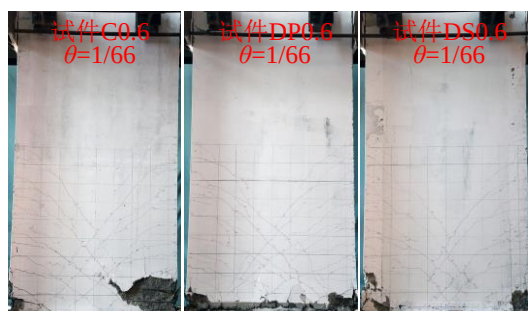
(d) 试件破坏形态 ( n_d=0.6 )
