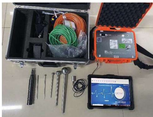
图 15 孔道压浆密实度冲击回波法仪器设备图
