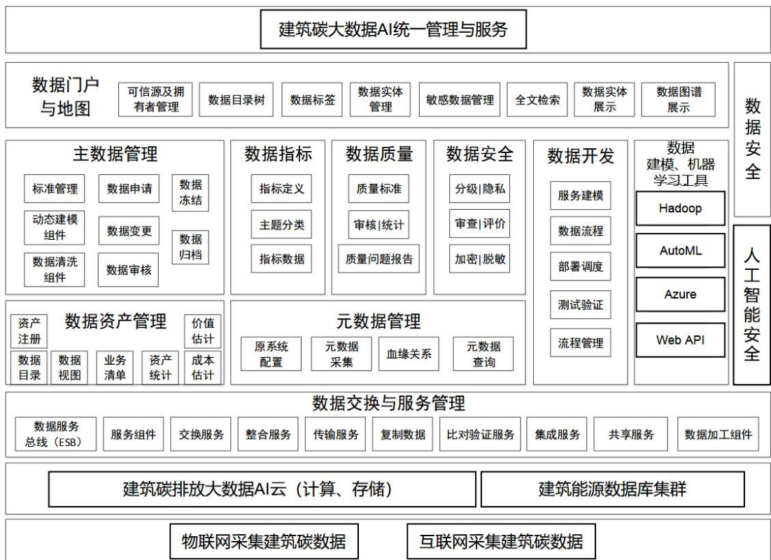
图 5.3.5 建筑碳排放云平台及其数智引擎示意图
