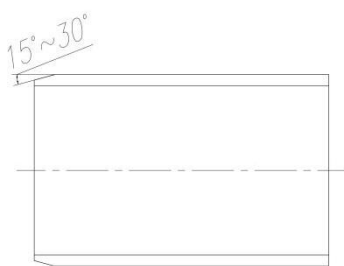
图1 AGR+管道倒角示意图
