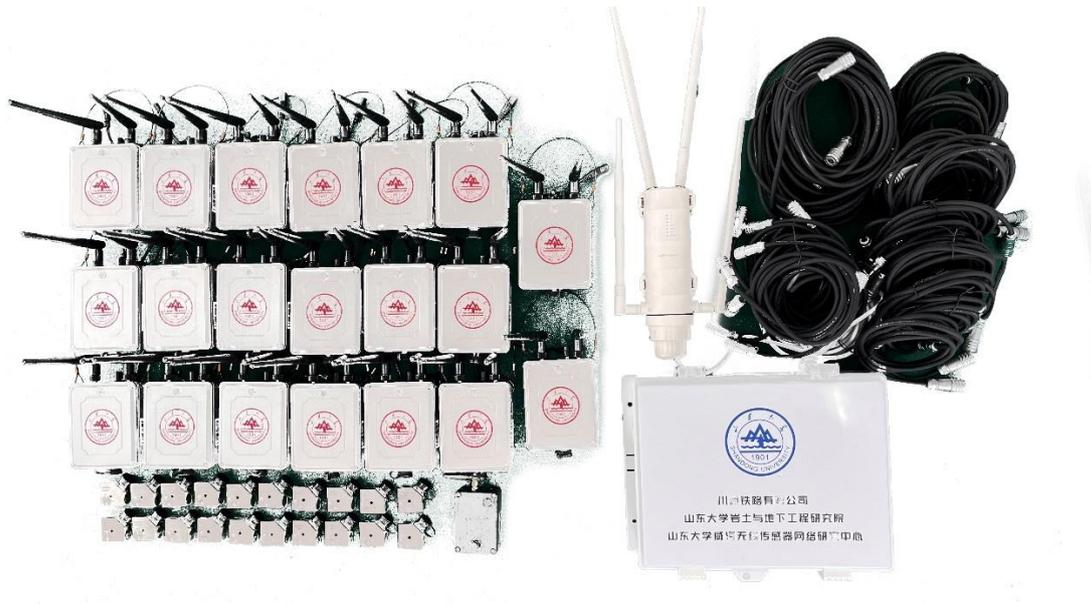
图 3 凿岩台车搭载式超前地质预报设备
