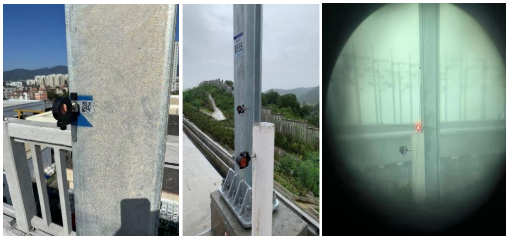
说明图 C.2.2 棱镜夹持安装效果图
